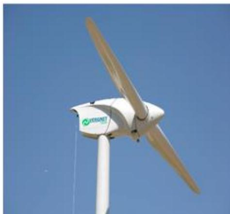
**Рисунок 5 – Внешний вид двухлопастного ветрогенератора**
