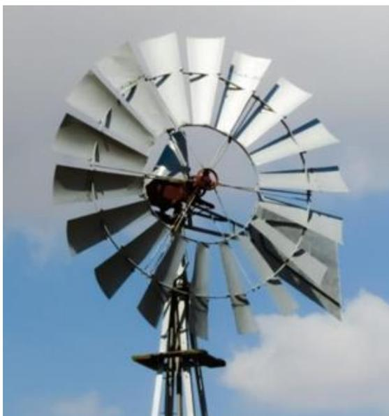
**Рисунок 7 – Внешний вид многолопастной ВЭУ**
